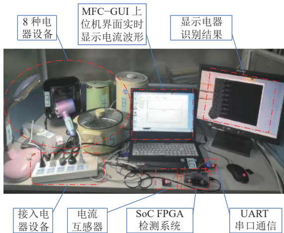
图 4 电器负荷在线识别平台
