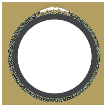
(b) 塌方掉块造成的空洞
