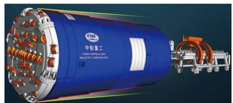
图1 青岛地铁2号线双护盾TBM隧道
