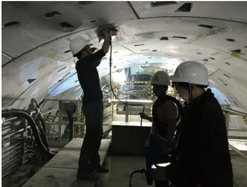
图7 管片壁后豆砾石分布地质雷达测试
