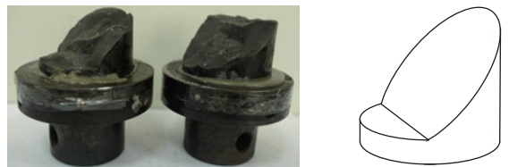
图3 砂岩试件S20破坏形态及简化破裂面
