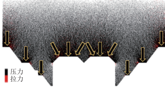
图 14 工况T1土体颗粒接触力链
