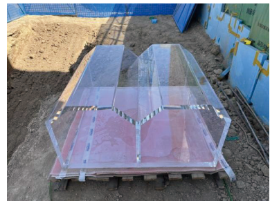
图1 梯形拱明洞试验模型
