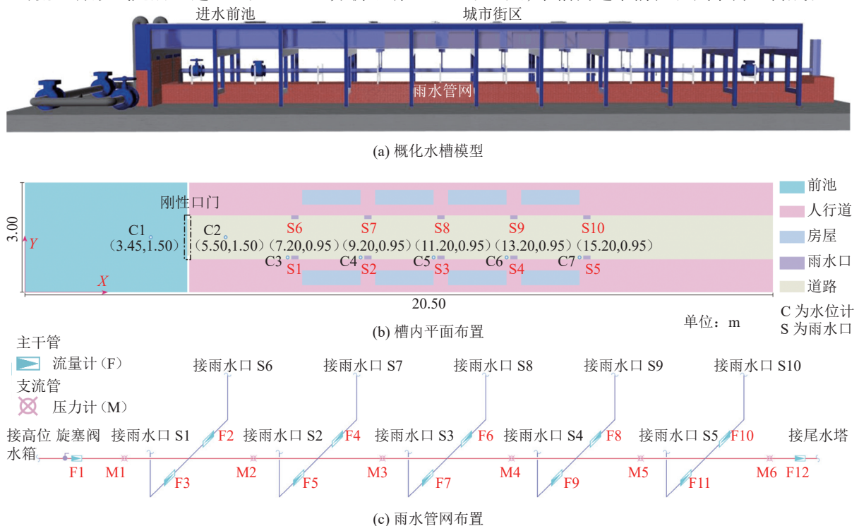
图1 概化水槽模型及测量仪器布置
